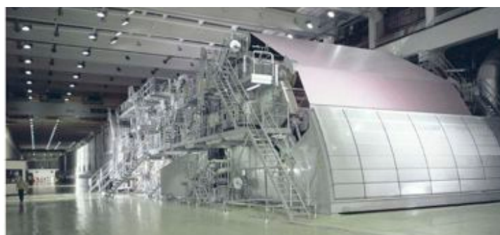
Figure 5. Machine à papier moderne (source : Copacel)
