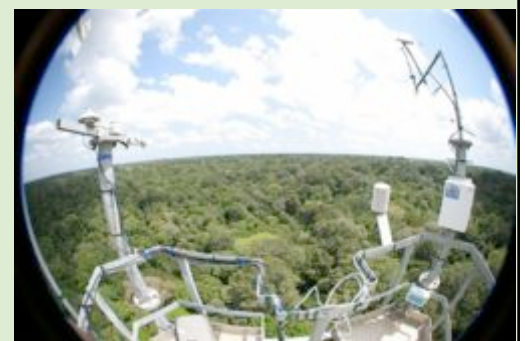
Figure 3. Guyaflux : des capteurs placés en haut d'une tour de 55 m au-dessus de la canopée mesurent les échanges hydriques et gazeux entre la forêt et l'atmosphère - Photo Ecofog
