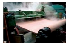
Figure 9. Le déroulage . Paramètre important la position de la barre d'appui par rapport au couteau
