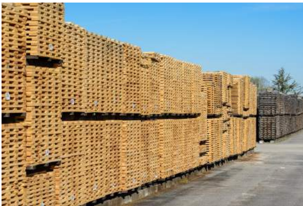
Figure 1. Séchage long, en plein air, des merrains de chêne Photo Taransaud
