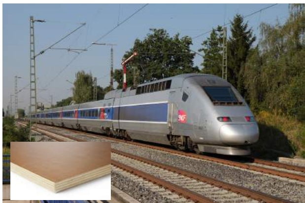
Figure 9. Plancher du TGV en contreplaqué multiplis
