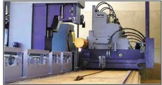
Figure 3c. Bâti et chariot . Source : Primultiini
