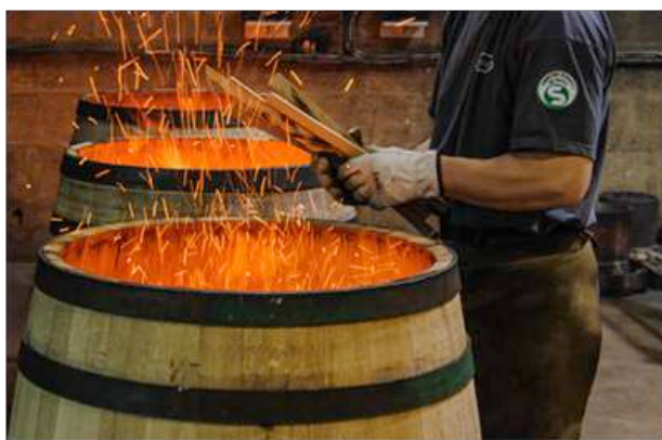
Figure 3. Bousinage : chauffe aromatique de la barrique Photo Taransaud
