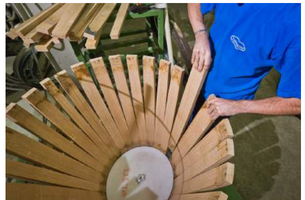
Figure 2. Mise en robe d'un fût pour le cintrage Photo Taransaud
