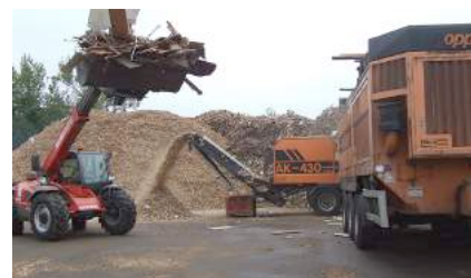
Figure 3. Le bois est réceptionné, trié puis broyé en différents calibres qui permettent d'alimenter des panneaux ou des chaufferies (Source : http://www.bati-recyclage.fr/activites/bois/ )
