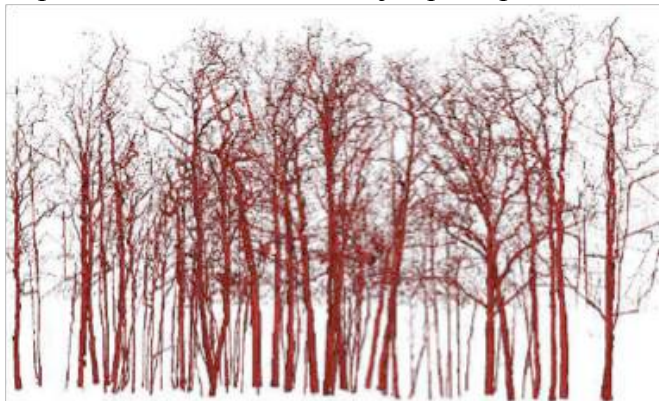
Figure 1. Numérisation de placettes de l'Inventaire forestier national par Lidar terrestre et reconstitution algorithmique de la géométrie des arbres d'une placette pour l'estimation du volume total aérien des ressources forestières. Source : d'après Hervé et al. 2016. Evaluation des ressources forestières pour la bioéconomie : quels nouveaux besoins et comment y répondre ? Innovations Agronomiques, 56 : 71-80).
