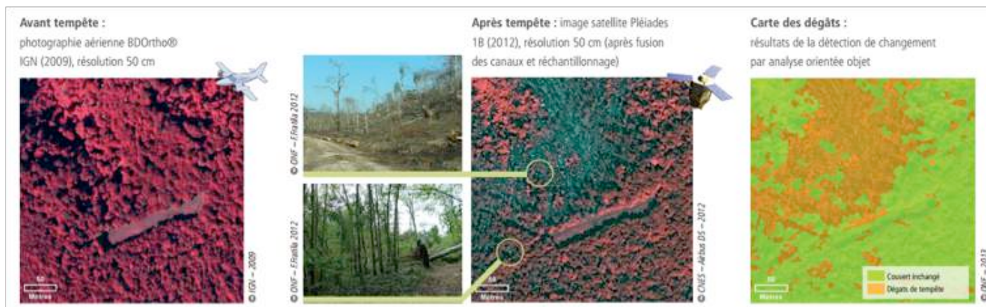
Figure 4. Détection de dégâts de tempête à partir de la comparaison entre une photographie aérienne avant tempête (BDOrtho® IGN) et une image Pléiades après tempête. Contient des informations © CNES –2014 – distribution Airbus DS / France – tous droits réservés.
