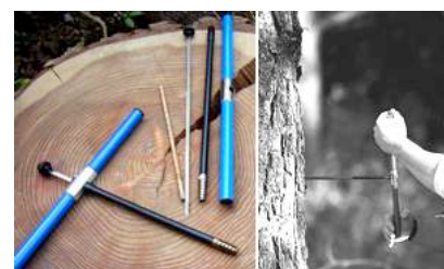
Figure 2. Mesure de la croissance en rayon à l'aide de la tarière de Pressler
