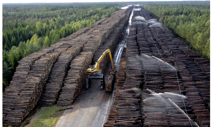
Figure 2. Après la tempête Gudrun en Suède (2005), piles de bois (13 m de haut, 1 km de long) stockées sous aspersion sur l'aérodrome désaffecté de Byholma totalisant 1 million de m 3 (photo Ola Nilsson)
