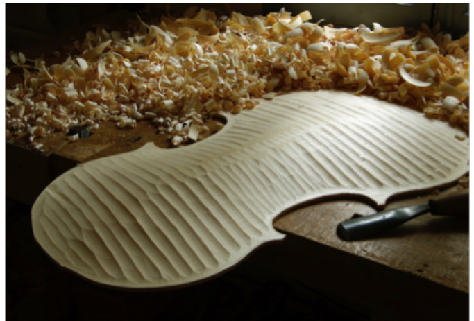
Figure 2. Préparation à la gouge de la table d'harmonie d'un violoncelle de concert. Épicéa de résonance débité sur quartier.
